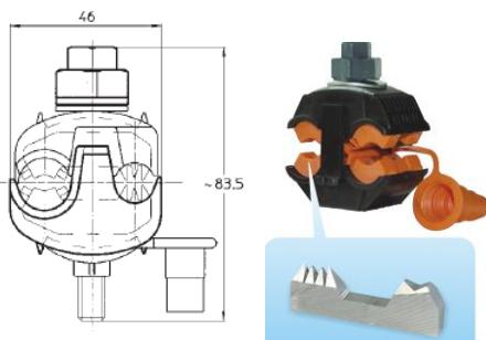
Kod konektora gde se na krajevima odvojnih vodova skida izolacija pre spajanja konstrukcija je takva da se glavni vod probija preko zuba na telu konektora i na kraju vijka, a odvojni vodovi se stežu inbus vijkom. Kompletno telo konektora je od legure aluminijuma. Ako nije korišćena legura potrebnih osobina imamo slučaj da se ne ostvari kontakt (zbog male tvrdoće materijala zubi ne probijaju izolaciju ili vijak prokliza).
