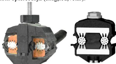
Obzirom na sve navedene karakteristike različitih tipova konektora treba uvek izabrati pravi tip konektora. Kod konektora koji služe za spoj glavnog neizolovanog i odvojnog izolovanog voda konstrukcija je drugačija. Na strani glavnog voda nemamo zube već površinu prilagođenu obliku provodnika, a na strani odvojnog voda zube za prodom kroz izolaciju.
